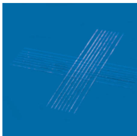
Prova di adesione con taglio trasversale.
